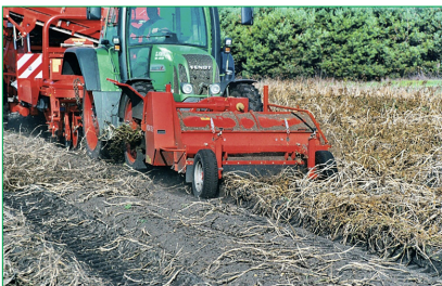
სურ. 7.14 ფოჩის მომცლელი წინა დაკიდების მანქანა — სატრაქტორო აგრეგატი ასრულებს ერთდოულად ფოჩის მოცლისა და კარტოფილის ალების ოპერაციას.
