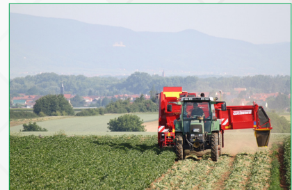
სურ. 7.16 კარტოფილის ამლები მისაბმელი კომბაინი თვითმცლელი ბუნკერით
