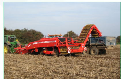
სურ. 7.17 კარტოფილის ამლები მისაბმელი კომბაინი დამტვირთი ელევატორით
