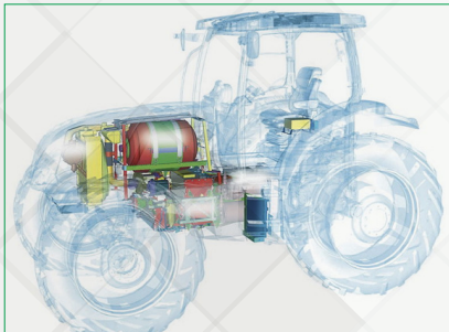
სურ 1.7 ტრაქტორი წყალბადზე მომუშავე ძრავით (New Holland)
