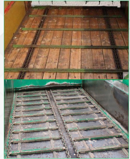
სურ. 4.7. ორგანული სასუქის შემტანი მანქანების ძარა ზედხედში: მარცხნივ ერთსექციანი, მარჯვნივ ორსექციანი.
