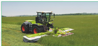
სურ. 8.14 როტორული ტიპის სატრაქტორო სათიბელები სხვადასხვა რაოდენობის სამუშაო ორგანოებითა და მოდელების განით
