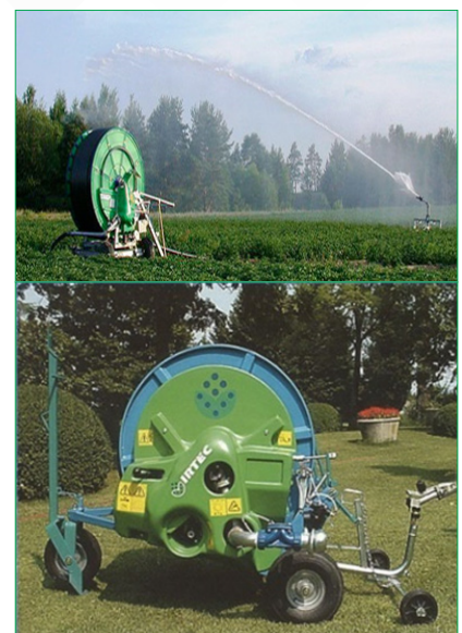
სურ. 6.1 დოლური ტიპის საწვინარი მანქანა Irtec (იტალია)
