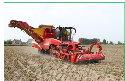
სურ. 7.18 კარტოფილის ამლები თვითმავალი კომბაინი
