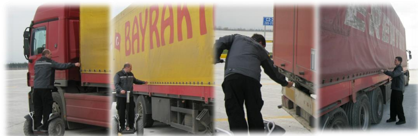
ე) შეამოწმეთ, რომ დასალუქი ზონარი არ იყოს გადაბმული, ის უნდა იყოს დაჭიმული, ასევე ე.წ. „ტენტი“ არ უნდა იყოს შეკეთებული არაქარხნული წესით
