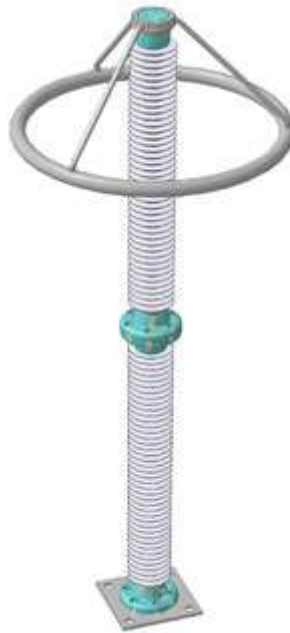
ნახ. 1.22. OPH 27-220 ტიპის გადაძაბვის არაწრფივი უეშლუდგელი ჭრილში (ა) და საერთო სახე (ბ): 1 – ზედა მილტურა; 2 – გარე იზოლაცია; 3 – მინაებოქსიდის ცილინდრი; 4 და 11 – დამცავი მოწყობილობა;
