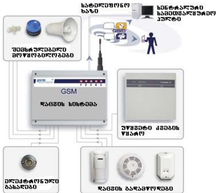
ნახ. 9.11. GSM დაცვის სისტემის სტრუქტურული სქემა
