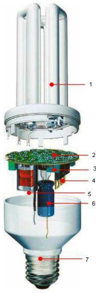
ნახ.7.10. ენერგოდამზოვი ნათურის ძირითადი შემადგენელი ნაწილები
