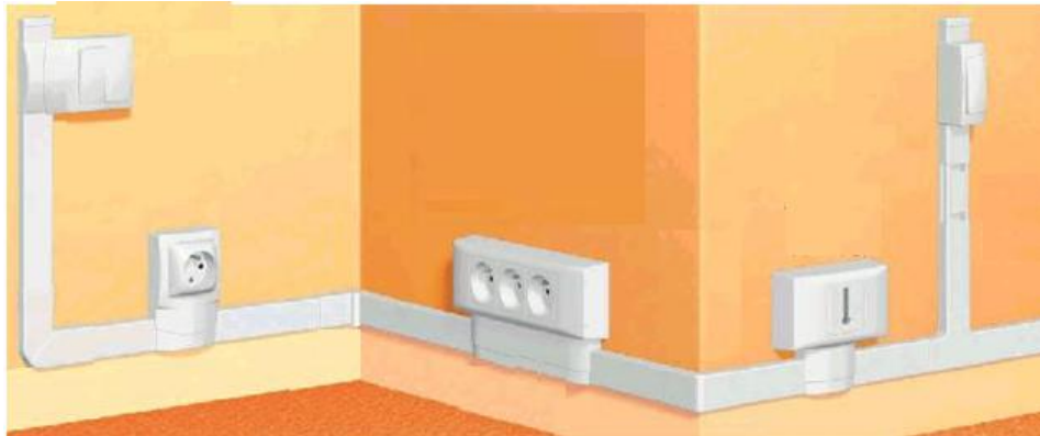
ნახ.8.32. საკაბელო არხებში შესრულებული ელექტროგაყვანილობა
