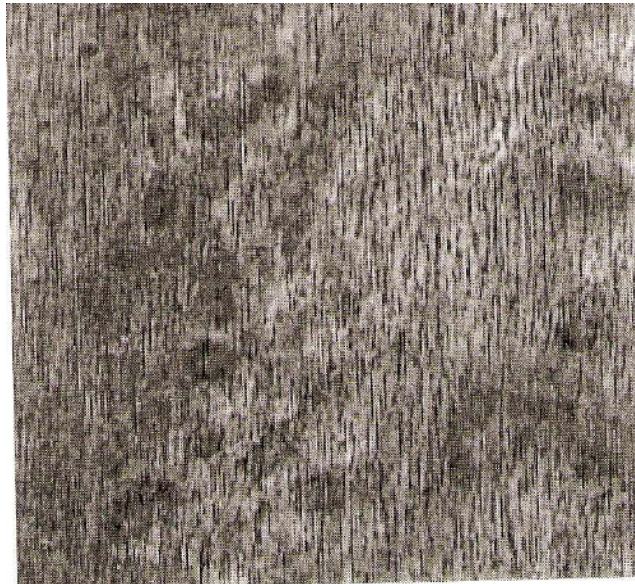
ნახ. IV-5. როდესაც საღებარი ხეში სრულად ვერ აღწევს, ზედაპირი უამრავი ლაქით იფარება. ეს დეფექტი ხშირია გამხსნელში ხსნადი ჭარბი საღებრით დაფარულ მაგარ ხის ჯიშებზე.
